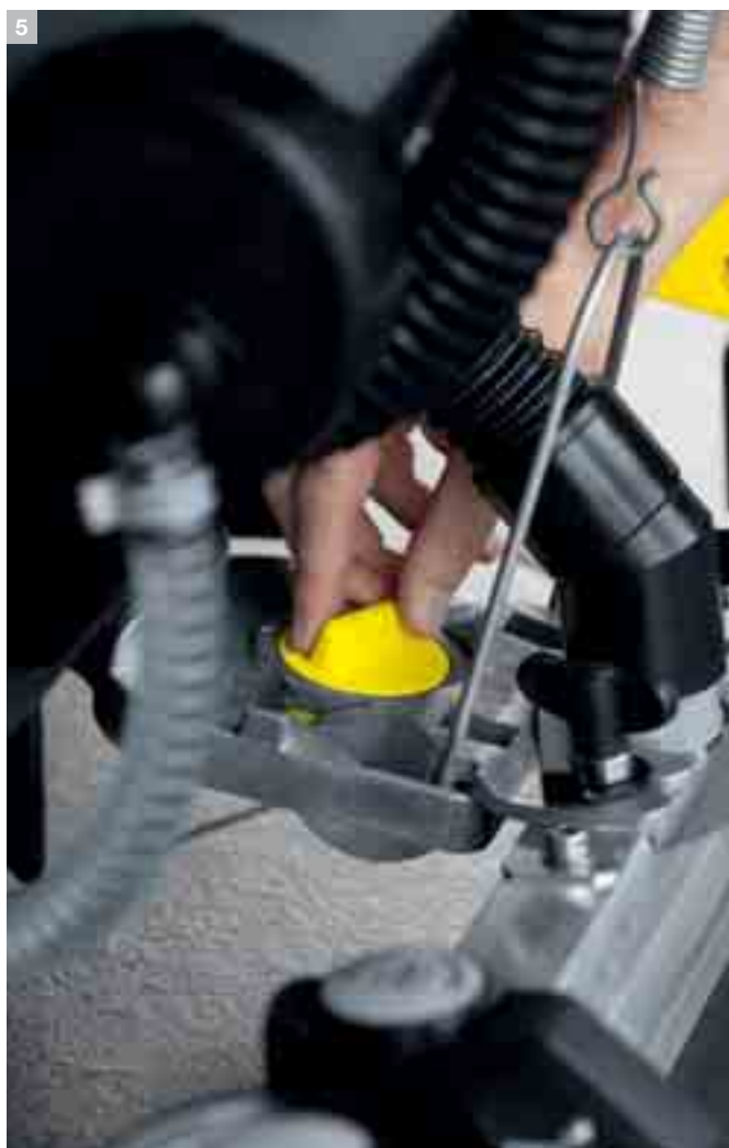
5 Одним движением руки: регулировка положения всасывающей балки
